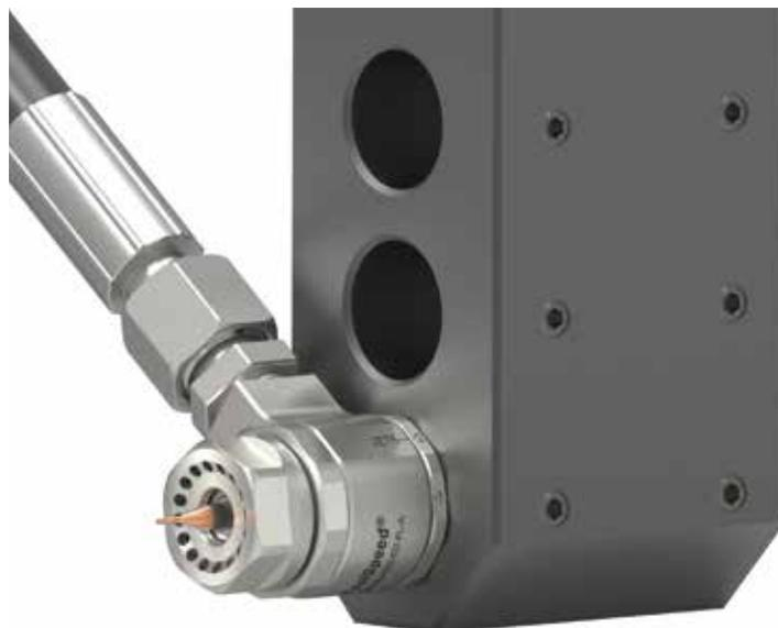
CoolSpeed® Flex ist eine neuartige, turbinenangetriebene Ultra-High-Speed-Werkzeugspindel. Durch die einstellbare Anzahl der Düsen (Jets) ist es möglich, CoolSpeed® Flex auch mit Kühlmittelpumpen zu betreiben, die einen Kühlmittelfluss von nur etwa 8 l/min erreichen.
